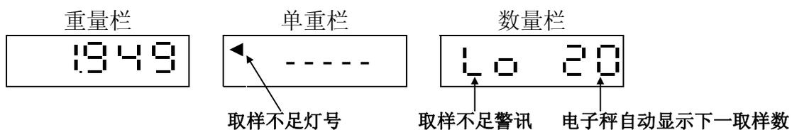
2. 重新取样后，若仍“取样不足”时，电子秤再显示下一取样数，须再重新取样。
